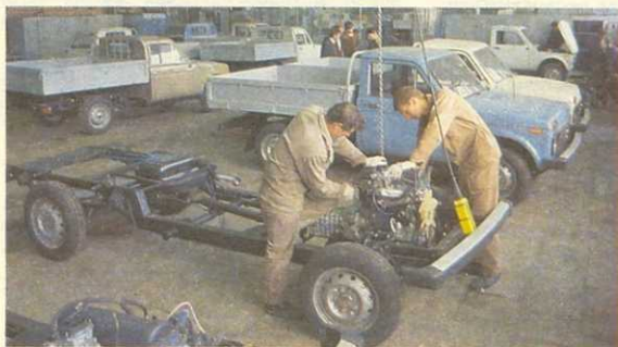
Сборка грузовиков: ни конвейера, ни роботов.
