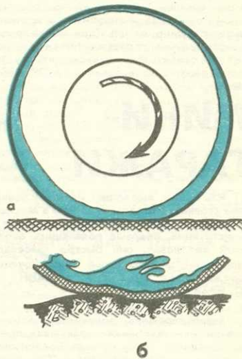
Распределение жидкости: во вращающемся колесе на стенде (а) и на дороге (б).
